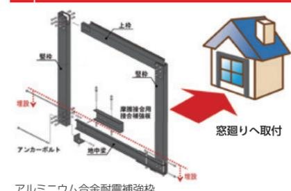
アルミニウム合金耐震補強枠 窓周りや壁面に補強枠を取り付けるだけで、建物の耐震性能を向上させます。
